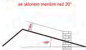
VÝŠKA KOMÍNA NAD PLOCHOU STŘECHOU se sklonem menším než 20°
